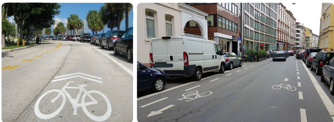
სურათი 34: საველოსიპედო-საავტომობილო ზოლის ისრებით („sharrows“) მონიშნული საზიარო სივრცის მაგალითები (ფოტოები: team red)
